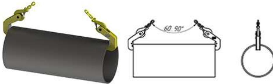
Во время работы с торцевыми захватами следует следить за тем, чтобы поверхность трубы (груза) оставалась чистой, без ржавчины, заусенцев и прочее. Неплотное прилегание к грузу снижает грузоподъемность захвата.
